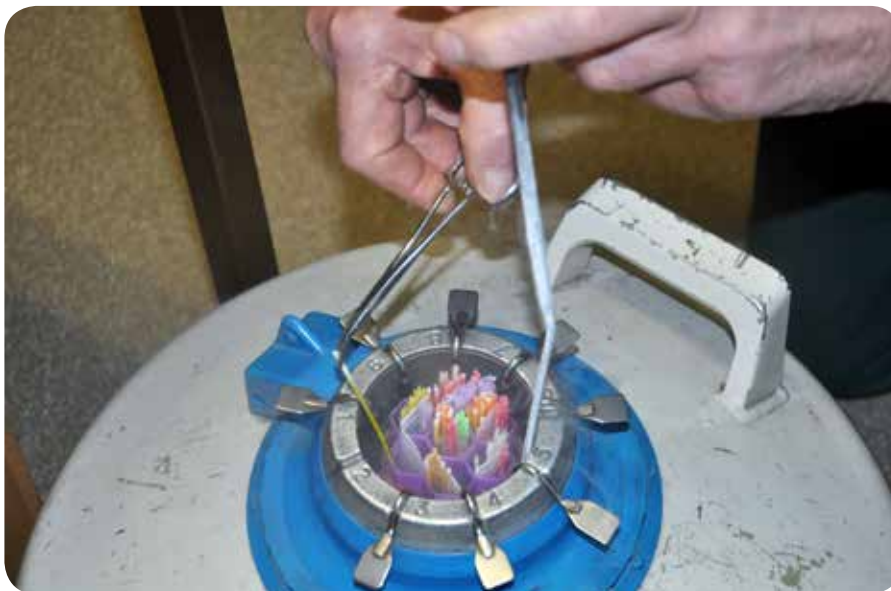
Figure 1 : Il est particulièrement important de vérifier régulièrement le niveau d'azote liquide dans la cuve de stockage afin de s'assurer que les paillettes soient, idéalement, immergées en permanence.
